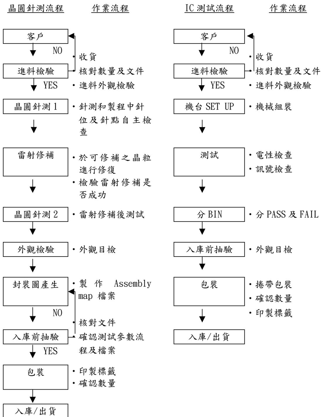
隨著 IC 之功能不同，IC 測試之流程亦隨之不同，但不論是何種功能之晶片，均可概分為晶片測試與成品測試兩個階段。晶片測試在晶圓完成後執行，係為在封裝前區分晶粒之良莠，避免不必要之後段封裝成本浪費。成品測試係在封裝後執行，以確定封裝過後之 IC 其品質是否符合要求及其品質之穩定性。
